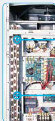
Aletas de alumínio com proteção anticorrosão
