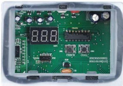
Janela de verificação da placa de quadro elétrico. É possível observar diretamente o status de funcionamento a partir do display de LEDs e pressionar diretamente o botão FORCE COOLING / CHECK (REFRIGERAÇÃO FORÇADA / VERIFICAÇÃO).
