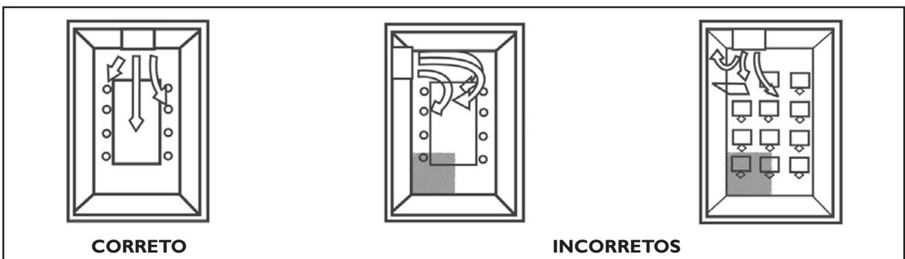
FIG. 17 - POSIÇÃO DA EVAPORADORA NO AMBIENTE
