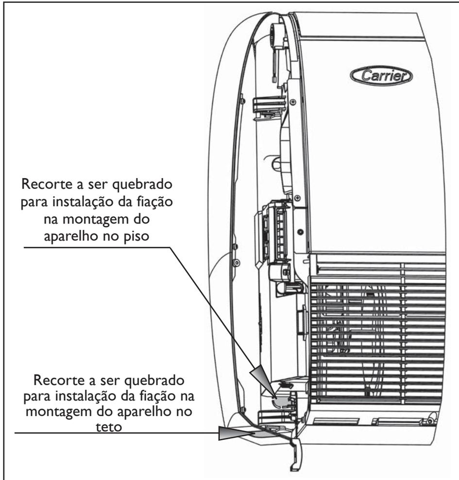
Conforme sua instalação no piso (console) ou no teto (under ceiling), existem diferentes posições por onde deve passar a fiação elétrica da evaporadora. A figura 47 mostra as posições onde se deve quebrar o recorte existente na tampa lateral esquerda da evaporadora para passagem da fiação.
