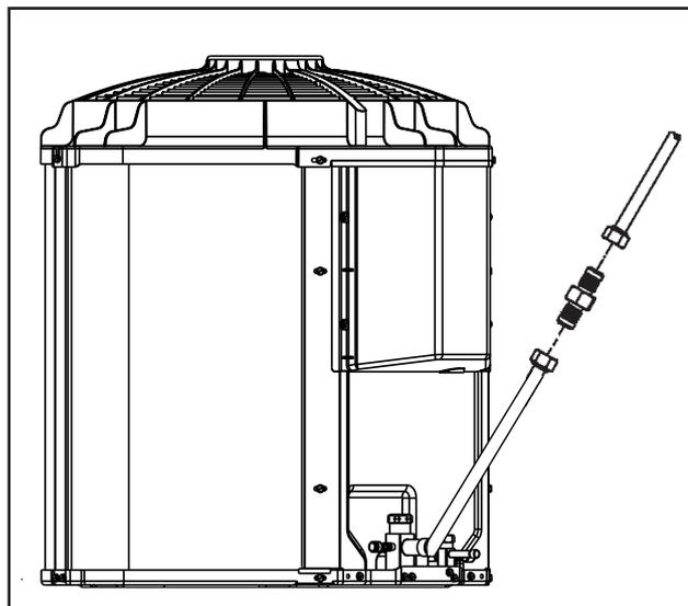
FIG. 44 - INSTALAÇÃO DO KIT SISTEMA DE EXPANSÃO
