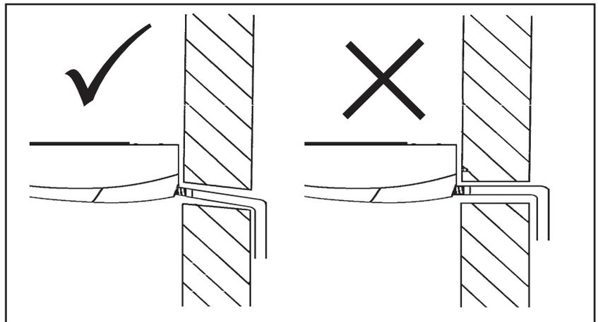
FIG. 24 - INCLINAÇÃO DRENAGEM
