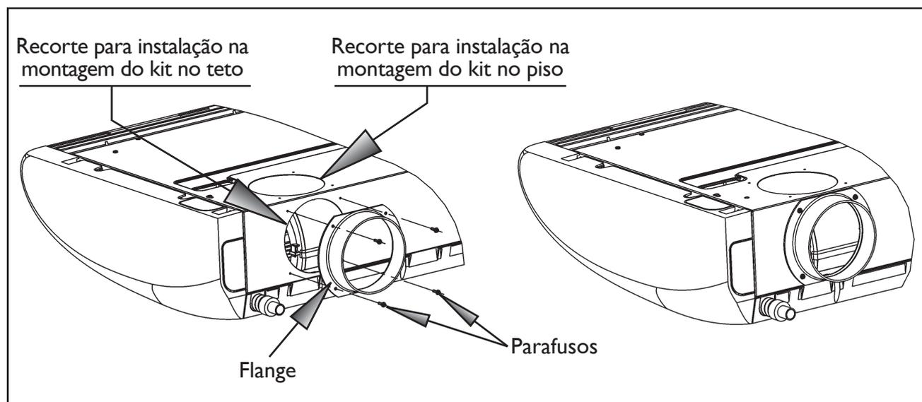
FIG. 26 - INSTALAÇÃO DO KIT RENOVAÇÃO DE AR
