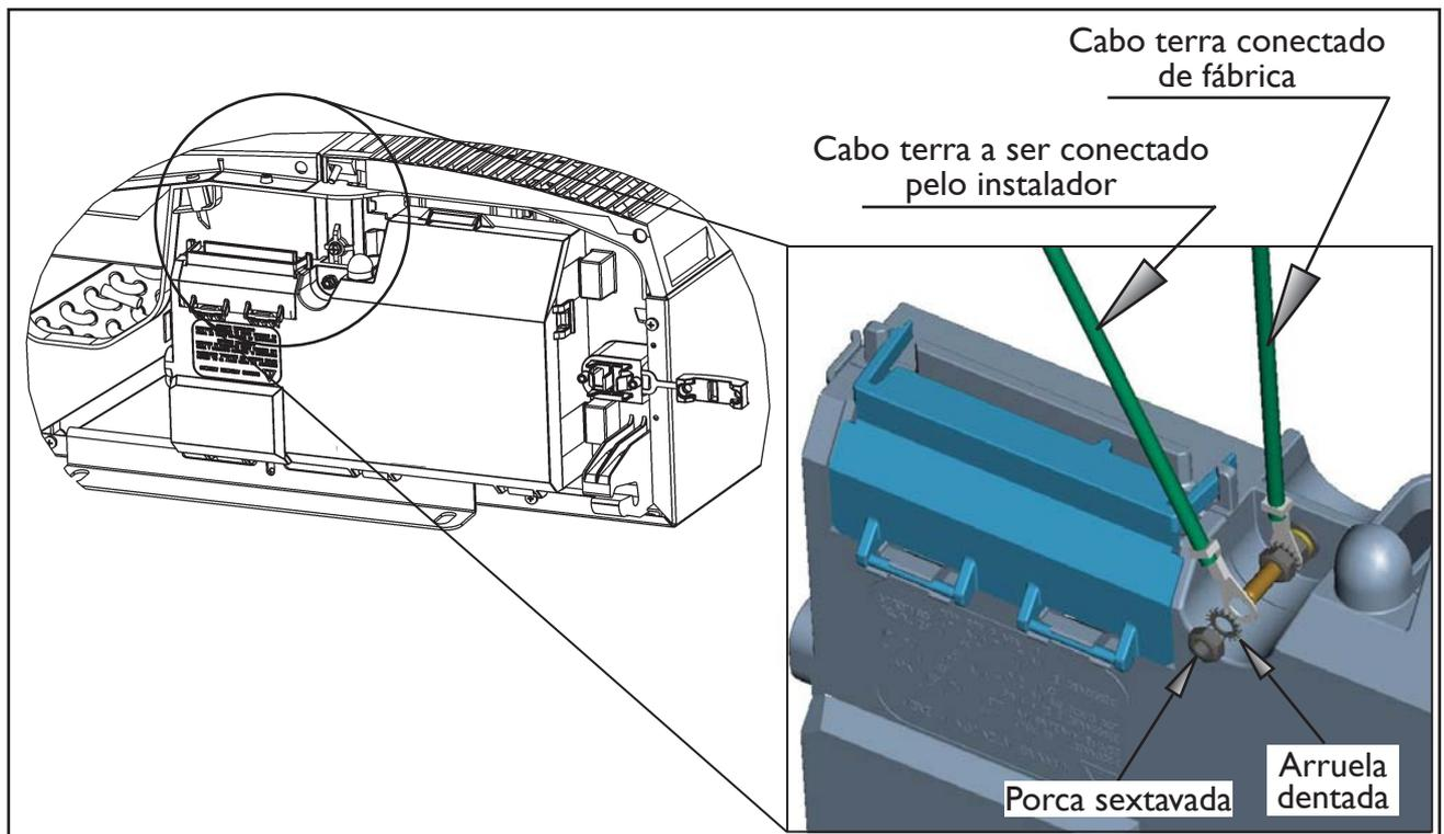
FIG. 48 - CONEXÃO CABO TERRA
